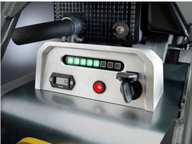
Compatec – система контроля уплотнения
